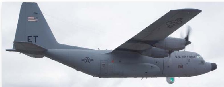
La piccola cupola sotto la pancia del C-130 costituisce la parte visibile del Advanced Tactical Laser. L'"occhio turchese" è tutt'altro che innocuo.
